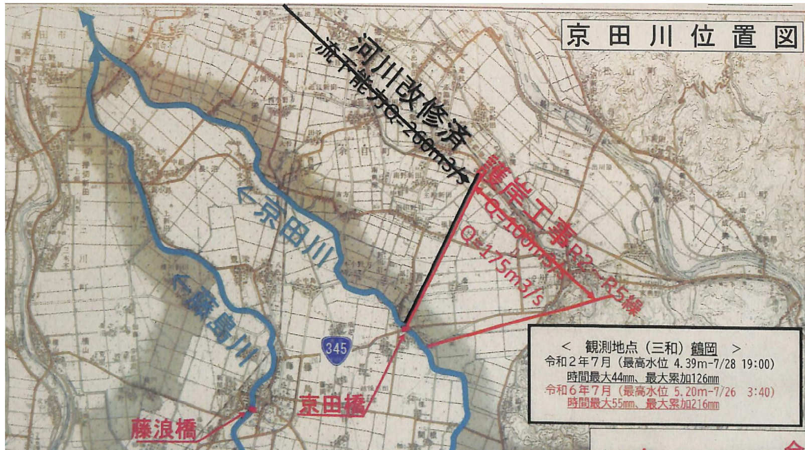
京田橋の下流は堤防が高く河川改修済で、上流の三和は護岸工事中
