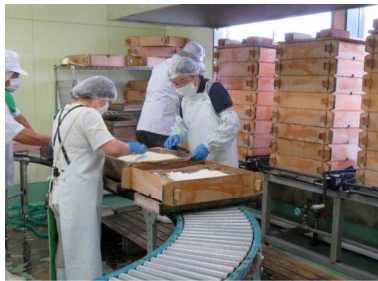
精米をセイロに移し蒸気で蒸す
