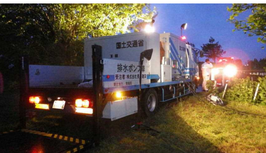
国土交通省の排水ポンプ車（彦九郎堰水門）
